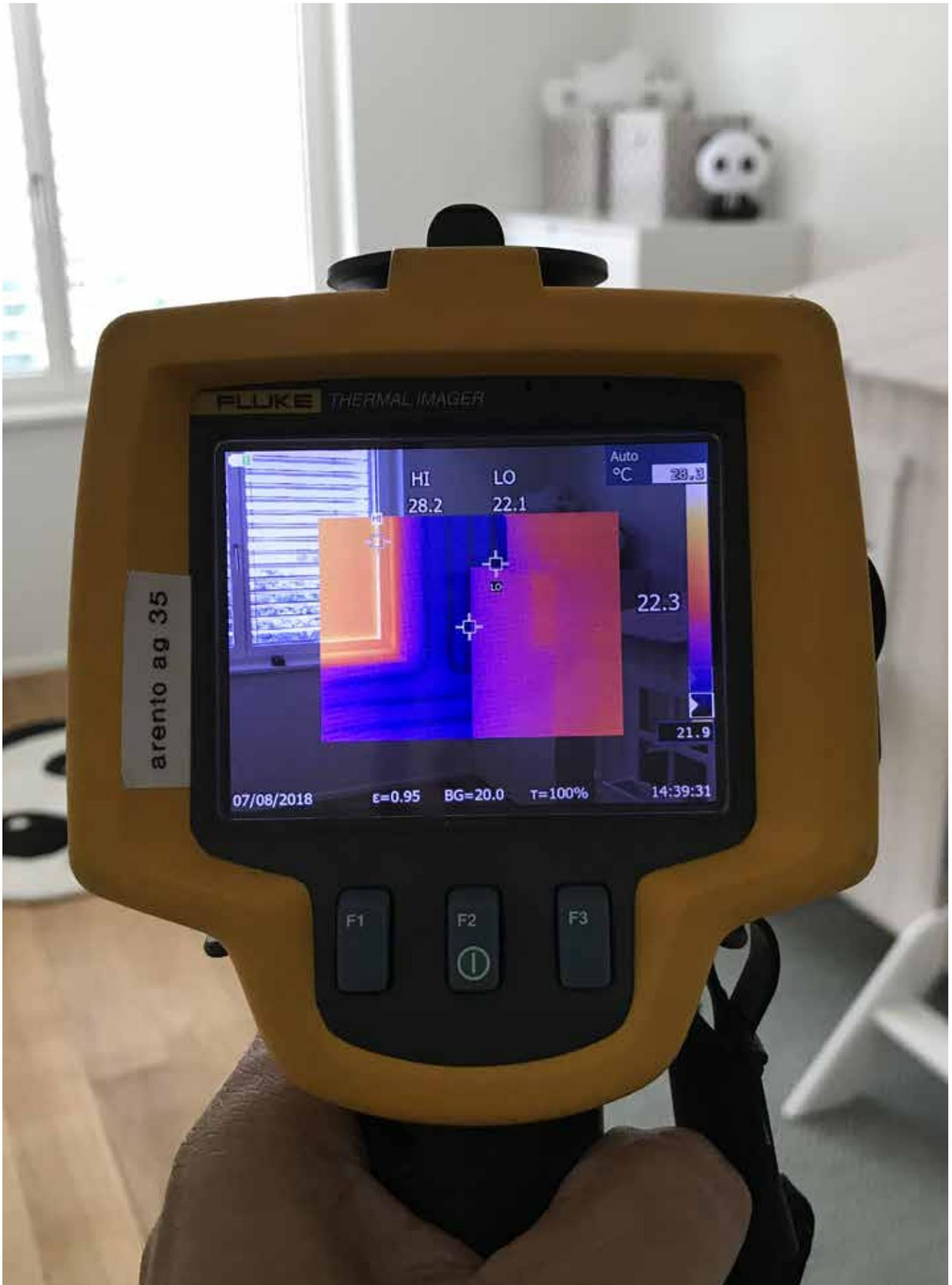
Infrarotmessgerät im Kinderzimmer: Mit Kälte aus dem Erdreich können Wände im Sommer zu kühlenden Elementen werden.
