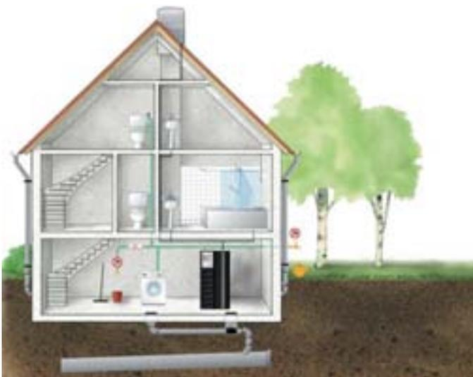
Grauwasseranlage zur Aufbereitung von häuslichem Dusch-, Bade- und Handwaschwasser für die Toilettenspülung, Waschmaschine und Gartenbewässerung.
